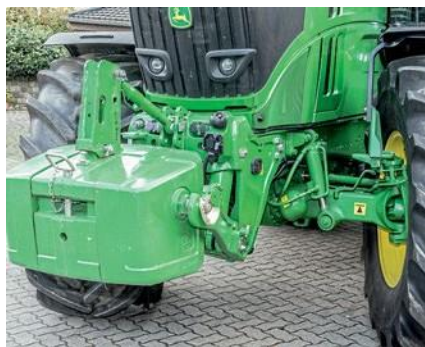
Das neue Fronthubwerk ist mit 5 t Hubkraft angegeben, die Zylinder der Vorderachsfederung liegen seitlich.
