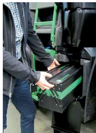
Werkstatt an Bord: Auf der rechten Seite hat eine komplette Werkzeugkiste Platz.
