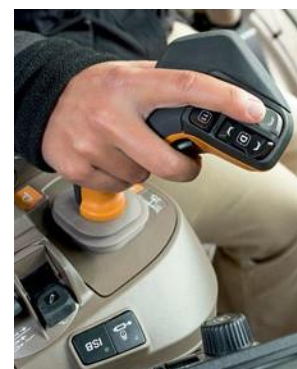
Der Wendeschalthebel links kehrt immer in die Mittelstellung zurück, da man auch mit dem Hebel rechts (bei gedrückter Aktivierungstaste) die Fahrtrichtung wählen kann.
